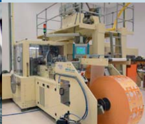
Nach dem Retrofit durch APA-Tec komplett neu aufgebaute Abfüll- und Verpackungsmaschine.
