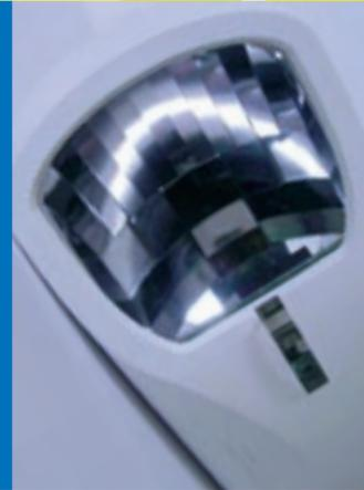
Passiv-Infrarot-Bewegungsmelder »comstar« von Telenot mit aktiver Folienüberwachung. Die normalerweise vorhandene Schutz- bzw. Filterfolie wurde entfernt, damit die Spiegeloptik sichtbar ist.
